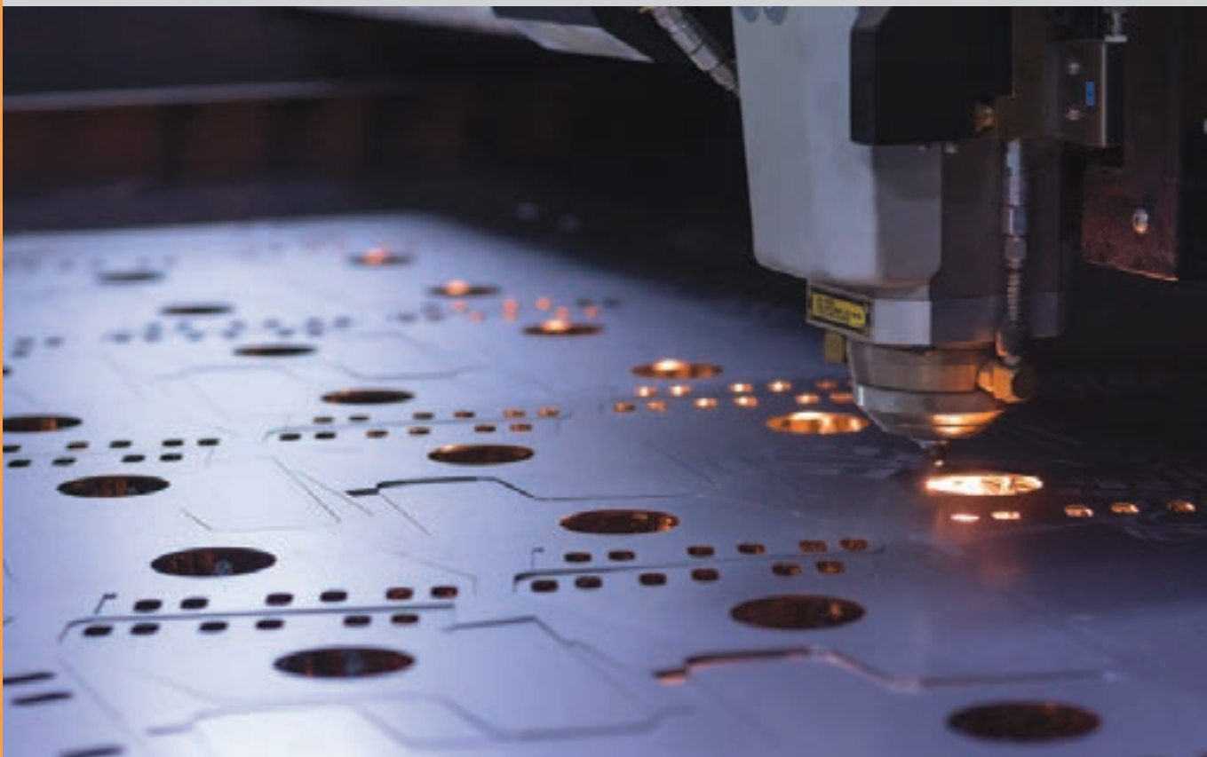
Figura 5.14 Tăierea unui metal cu un fascicul laser
